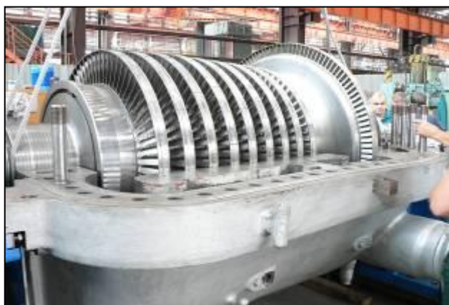
rys.10: Widok na wirnik podczas montażu.
