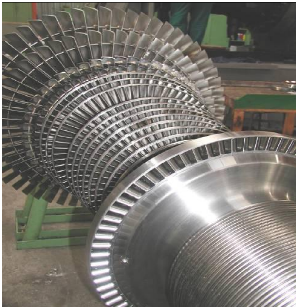
rys. 38: Wirnik turbiny kondensacyjnej EKOL z zamontowanymi łopatkami..
