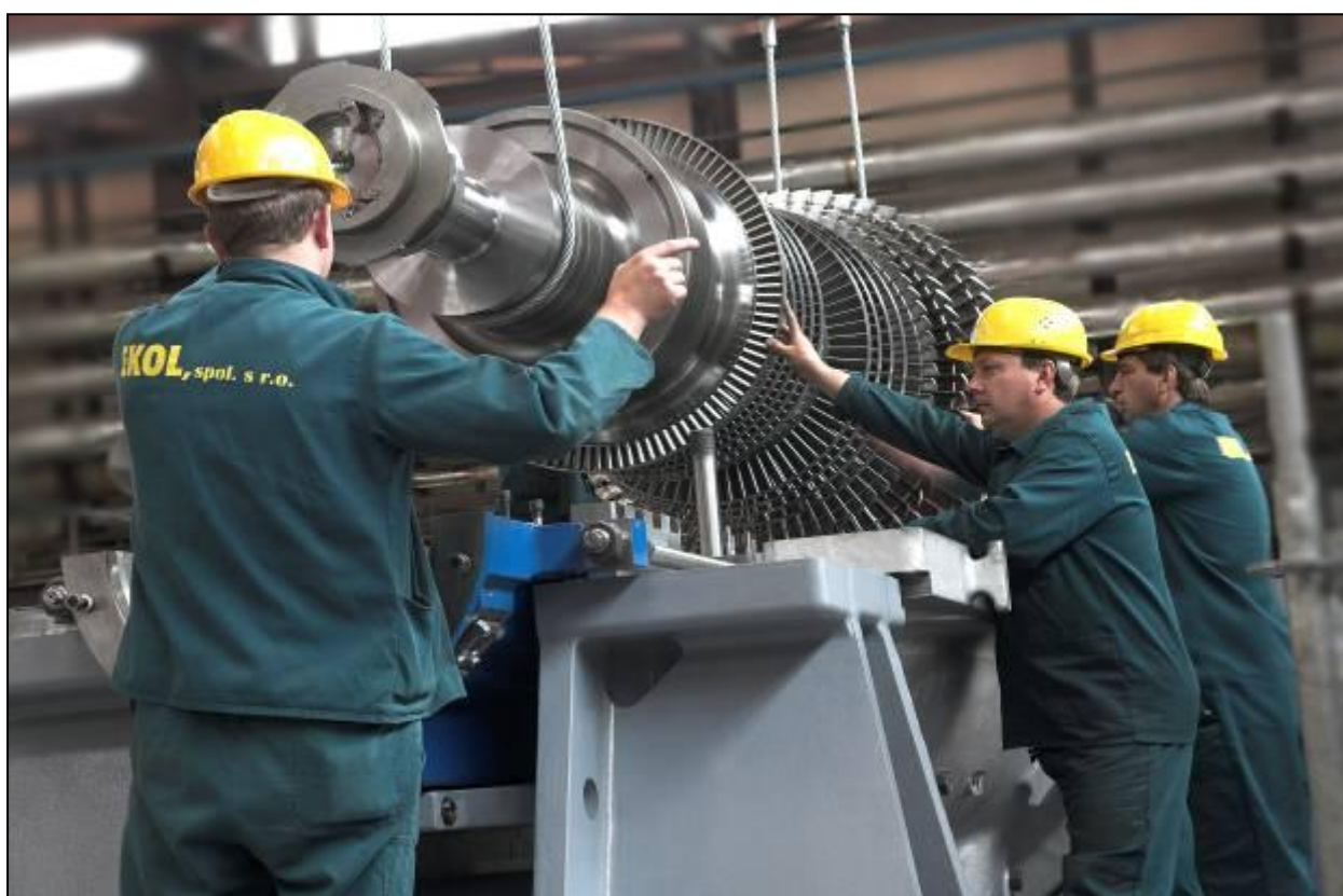
Rys.1 : Montaż wirnika turbiny parowej na własnej hali produkcyjnej firmy EKOL, spol. s r.o. Brno.
