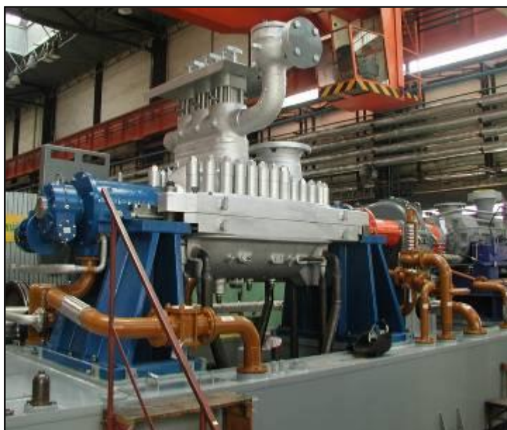
Rys. 7: Turbina na ramie podczas montażu w zakładzie produkcyjnym.
